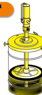
Sul livello del mare, la pressione dell'atmosfera è di 1 bar, pari a circa 1 Kg per cm<sup>2</sup>. Quando la pompa aspira il grasso dal contenitore, nella parte sottostante la membrana si crea una depressione e, simultaneamente, nella parte superiore si origina una pressione che varia da 370 Kg a 2000 Kg, a seconda dell'ampiezza della sua superficie.
