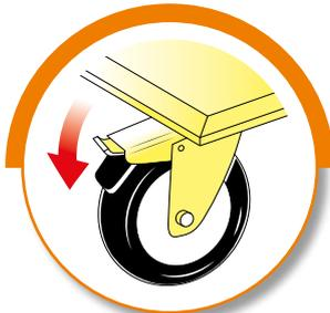
Die Radbremse ermöglicht das Feststellen des Laufwagens
