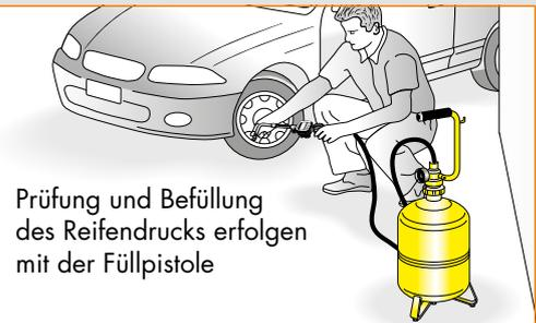
Prüfung und Befüllung des Reifendrucks erfolgen mit der Füllpistole
