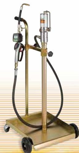
Kit zur Ölversorgung für Fässer von 20 - 220 l mit Pumpe R 3:1-5:1 und Ausgabepistole mit Zähler
