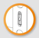
La posizione 2 è indicata per l'installazione dell'avvolgicavo "in batteria" (soffitto parete/pavimento o banco) in quanto la rotazione viene bloccata dalla staffa che crea un incastro con i carter dell'avvolgicavo.
