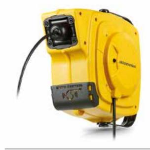
Gli avvolgicavo della serie 280 e serie 290 possono essere dotati di un freno che agisce durante il riavvolgimento del cavo. Questo accessorio limita la velocità massima di rotazione rendendo sicuro anche il riavvolgimento accidentale non controllato. La versione dotata di frizione, viene contraddistinta dalla placca "SPEED CONTROL"
