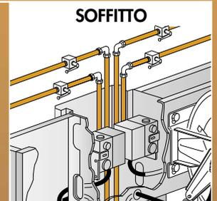
Predisposizione interna per il montaggio di pulser monovalvola e bivalvola per il funzionamento con impianto FCS.
