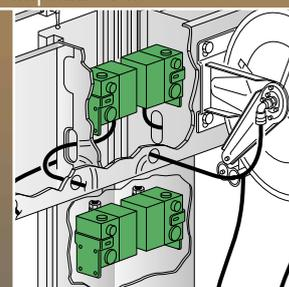
Il collegamento all'impianto può essere realizzato a pavimento.
