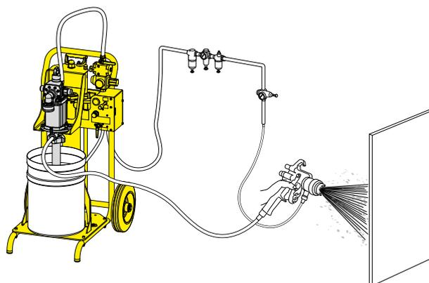
Sistema di distribuzione dei fluidi (vernici, lubrificanti, liquidi protettivi, ecc.) alimentato da pompa montata su fusto in postazione mobile ed erogazione con pistola a spruzzo.
