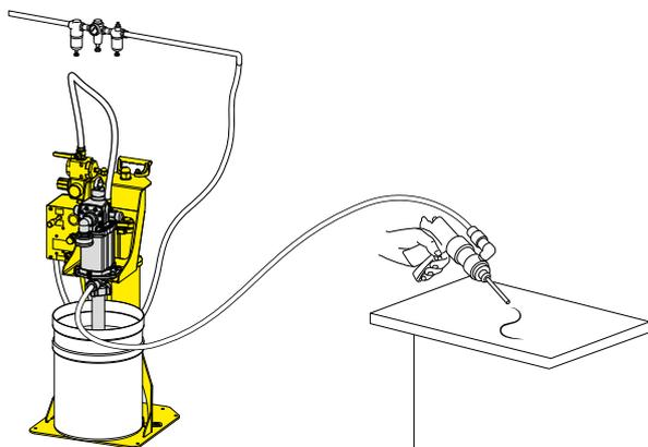
Sistema automatizzato per l'erogazione di quantità preselezionate di fluidi (inchiostri, vernici, grassi...), alimentata da pompa montata su fusto, con sollevatore.
