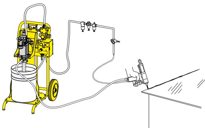
Applicazione di sigillanti, adesivi, grassi, ecc., mediante speciale pistola erogatrice alimentata da pompa montata su fusto in postazione mobile.
